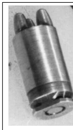
Vicestřelového náboje – TRIPLEX do upravené pistole Colt 1911 A1 (za povšimnutí stojí uříznutý okraj nábojnice sloužící k přesnému umístění náboje v nábojové komoře)
