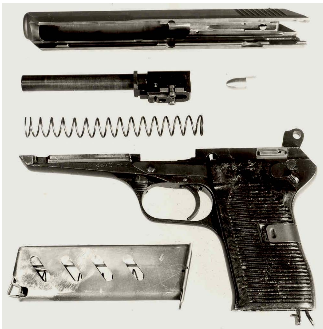
U beznábojnicového střeliva ráže 9 mm se na pokusy využívala upravená pistole ČZ vz 52.
